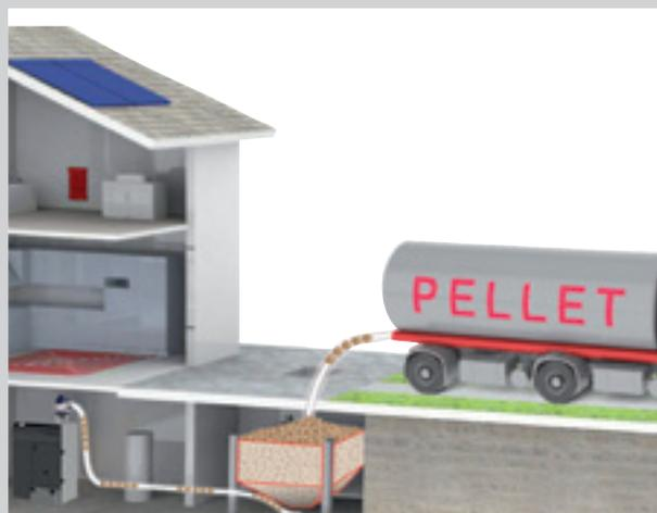
Esempio di approvvigionamento pellet tramite autobotte
