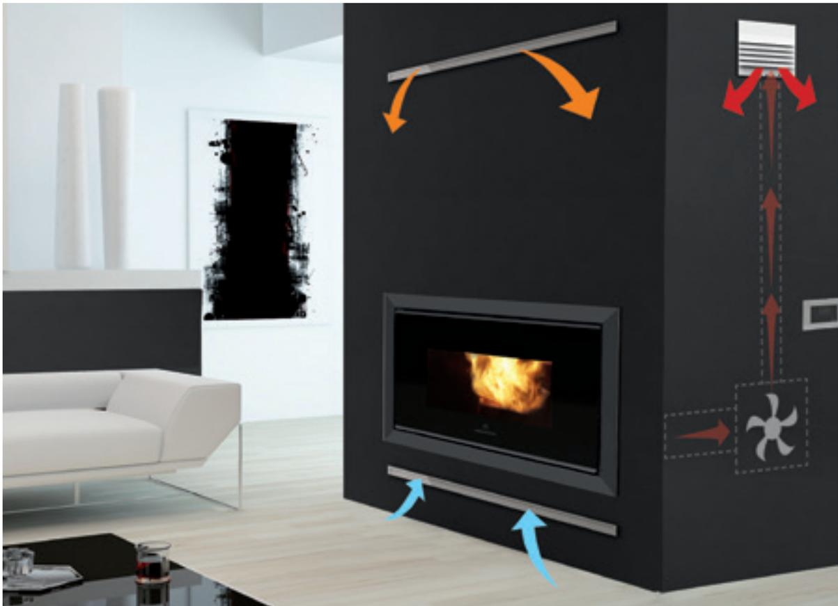
Esempio di canalizzazione con focolare a pellet.
